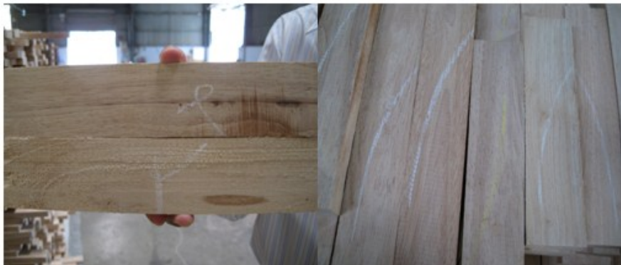
Hình 12. Đánh dấu nhận dạng hàng lỗi và hàng đạt yêu cầu đối với mặt trên và mặt dưới của các phôi gỗ dùng để ghép mặt bàn
