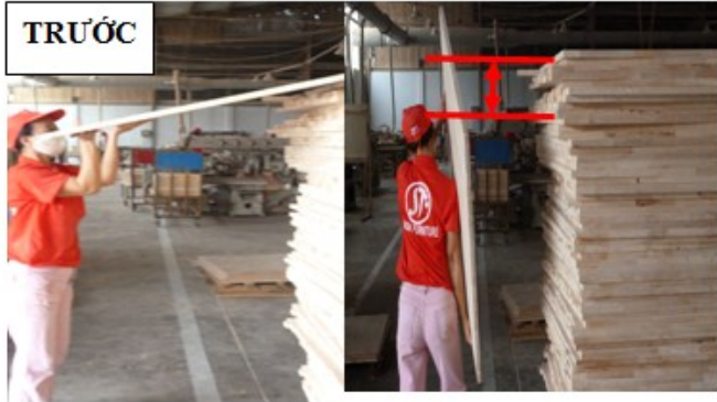
Hình 6. Chiều cao các mặt bàn cao quá đầu công nhân. Mỗi lần lấy nguyên liệu, công nhân đứng máy phải với tay và nhón chân
