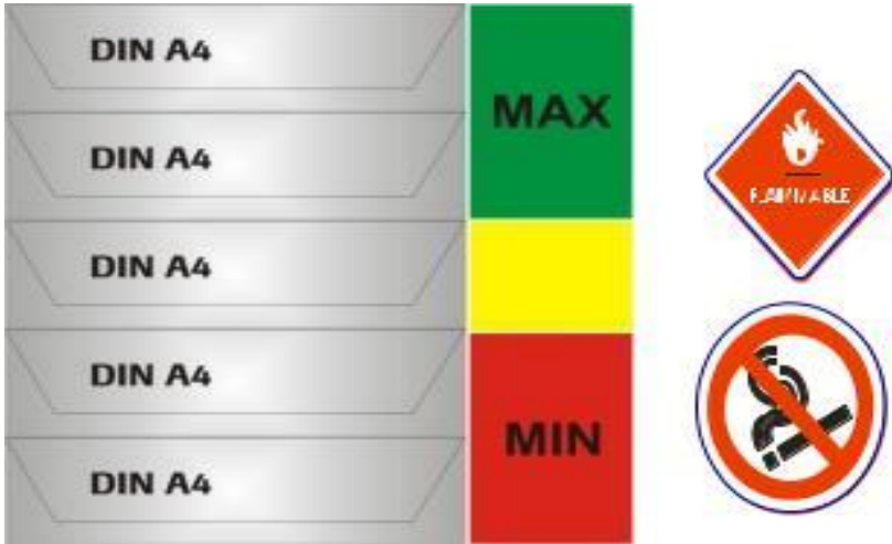
Hình 2.38. Trục quan tại các khu vực trong nhà máy để cảnh báo, nhận biết nguy hại/nguy hiểm
