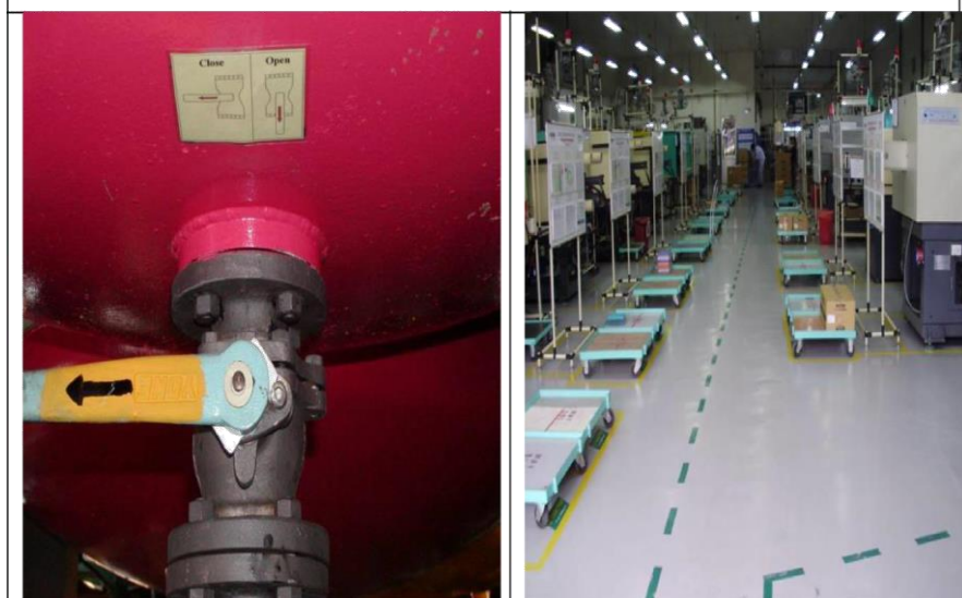
Hình 2.27. Phân khu bằng kẻ vạch và các dấu hiệu nhận biết giúp người công nhân dễ dàng thao tác trong sản xuất
