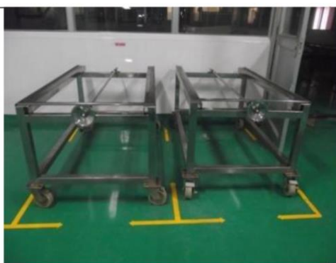
Hình 2.22. Sử dụng màu sắc, kẻ vạch để nhận biết các giai đoạn, tiến độ của kế hoạch sản xuất.
