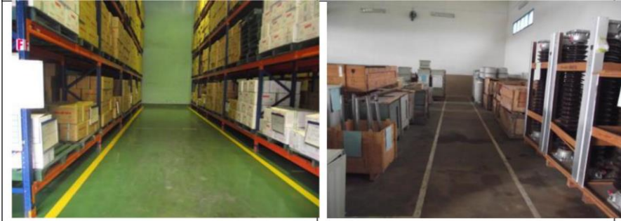
Hình 2.28. Sắp xếp, kẻ vạch và phân khu cho các đối tượng sản phẩm, bán thành phẩm, vật tư dụng cụ.
