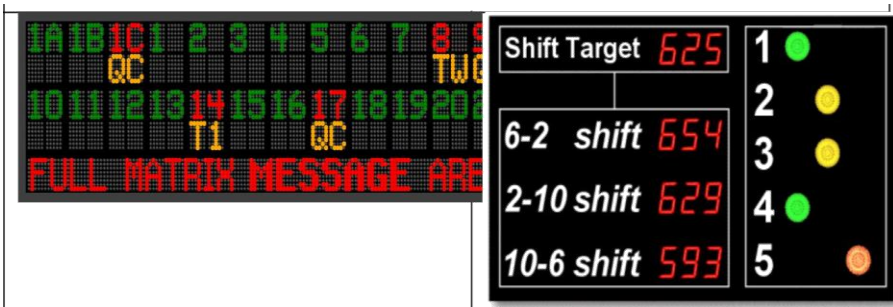
Hình 2.24. Kiểm soát CLSP trên chuyền bằng hệ thống Andon
