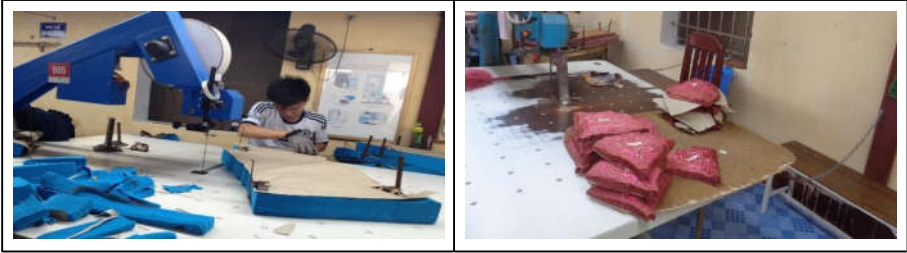
Hình 4.3: Lắp thêm xích chắn để hạn chế tác động của dao cắt
