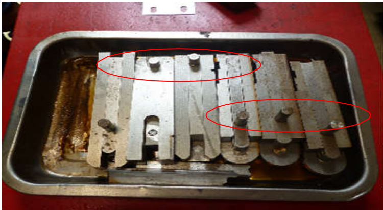
Hình 4.5: Các sản phẩm đặt vào trong khay cho công đoạn gọt tinh và đánh bóng chưa được sắp xếp một cách khoa học
