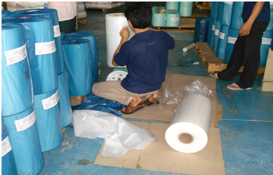
Hình 6.1: Công nhân phải xử lý cắt bỏ đi hàng thừa (do thiếu phương pháp đo khối lượng)
