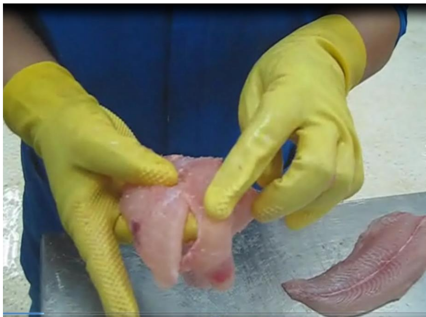
Hình 1.1: Sản phẩm lỗi cá phi lê bị tét đầu trong quá trình định hình
